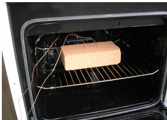
Slika 3. Samostojeći el. štednjak FC-4060 A WH i pripadajuća oznaka energetske učinkovitosti Slika 4. Položaj testne cigle unutar pećnice
